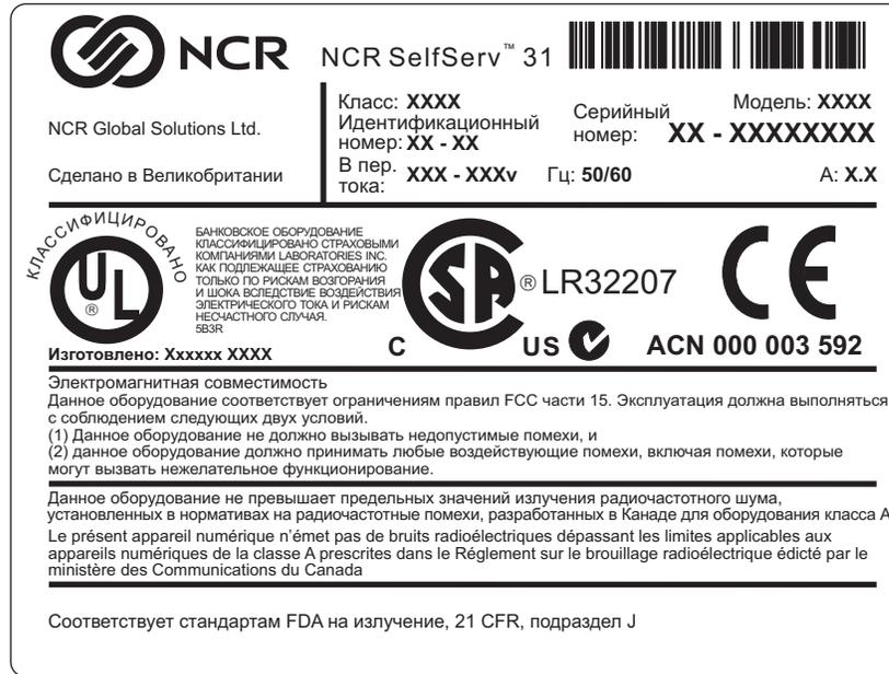
Продукт идентифицируется классом и четырехзначным номером модели. Каждый банкомат имеет уникальный серийный номер. Идентификационный номер используется для обозначения места изготовления банкомата.
